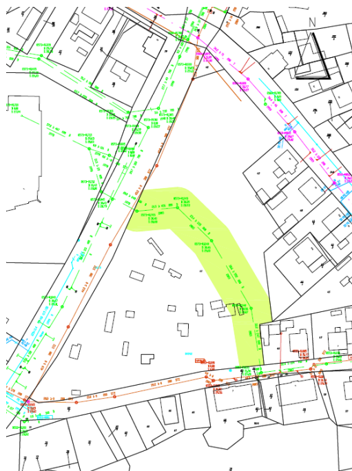
Abbildung 17: Lage der Niederschlagsentwässerung (Quelle: ZWAR)
