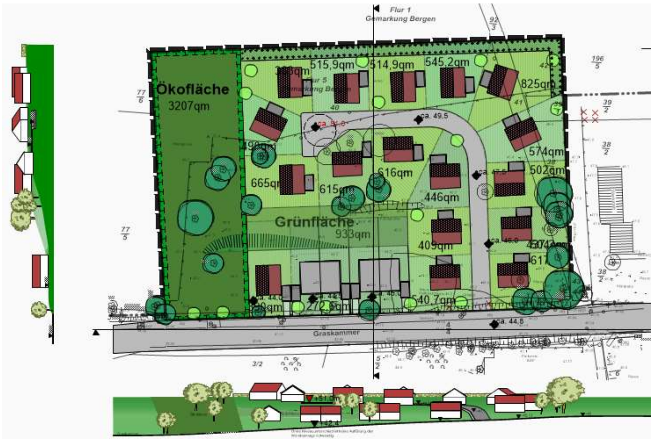
Abbildung 4: städtebaulicher Entwurf mit Geländeschnitten, raith hertelt fuß, 10/2018
